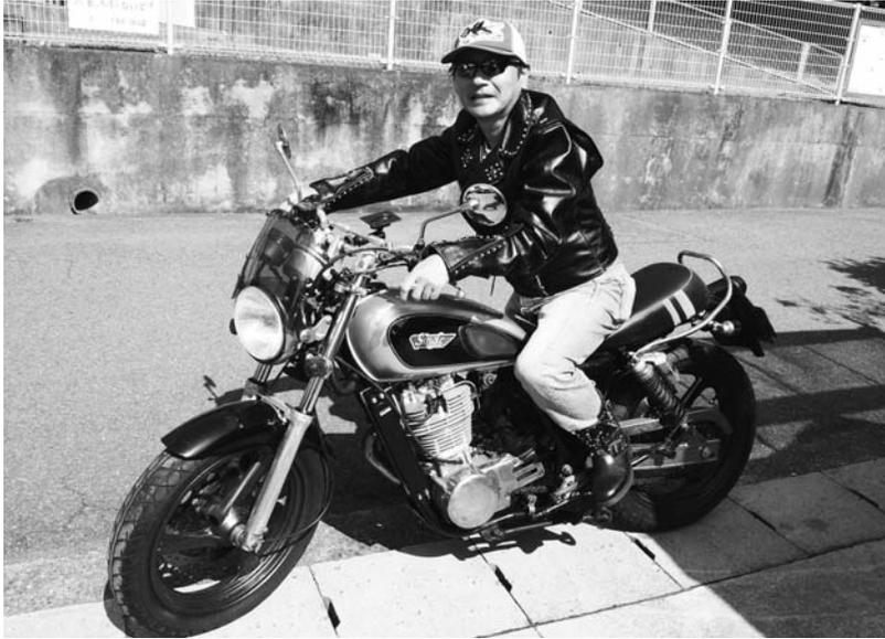
イクル空冷単気筒で日本の優秀な技術がないため、ガソリンを携帯用ガソリントankで買い一定の割合で2サイクル用のオイルを計って入れ混ぜ、それを車体のタンクに入れる必要がある。
